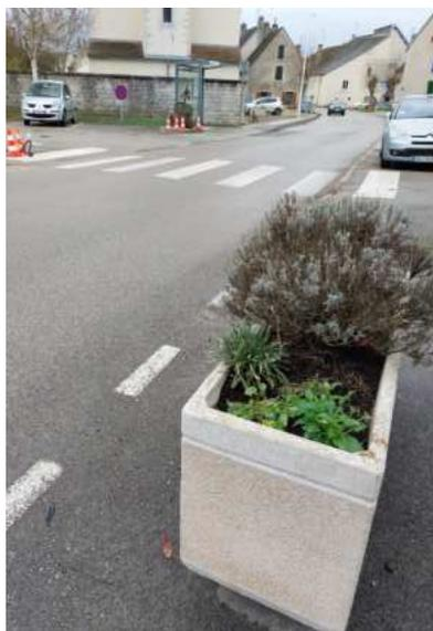
Pour sécuriser la traversée des piétons au niveau de l'arrêt de bus rue André Gleitz et du parking du lavoir, la Commune a décidé la mise en place d'une jardinière béton sur une place de parking permettant ainsi une meilleure visibilité pour les piétons et les automobilistes. Pour rappel ce passage piétons se situe dans une zone à 30km/h...
